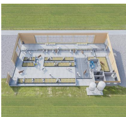
Bild 2: Grundriss des schlüsselfertigen Normstalls VMS für 45 Kühe
