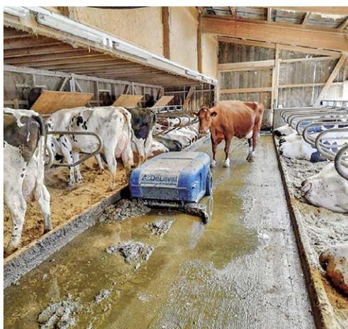
Le robot collector RC550 assure la propreté des couloirs de l'étable sur l'exploitation Steiner-Stöckli.
