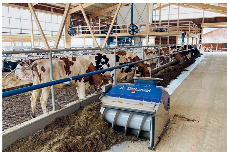
L'OptiDuo repousse les aliments tout en les rafraichissant.
