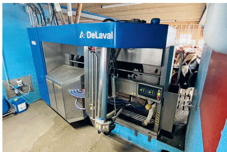
Photo du robot: Le VMS V310, doté d'un dispositif de mesure de progestérone et de cellules, travaille de manière rapide, silencieuse et fiable.
