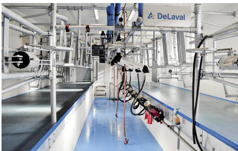
Confort de la vache et du trayeur: la salle de traite en épi 50° est équipée de 6 bras swing over. Les unités de traite sont utilisées des deux côtés de la salle de traite.
