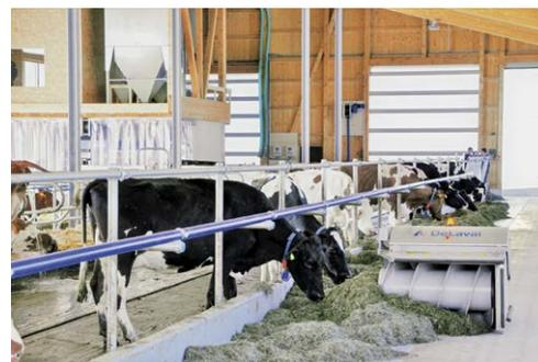
Le robot d'affouragement OptiDuo™ épand et mélange la ration de fourrage.
