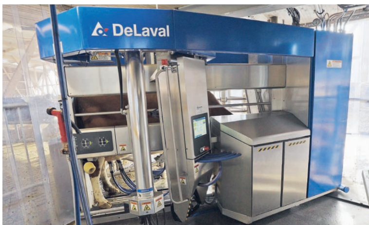
Le robot de traite VMS V310 est parfaitement adapté aux exploitations qui produisent du lait pour les fromageries, grâce à un nettoyage parfait des pis et à l'automatisation de nombreux processus de nettoyage.
