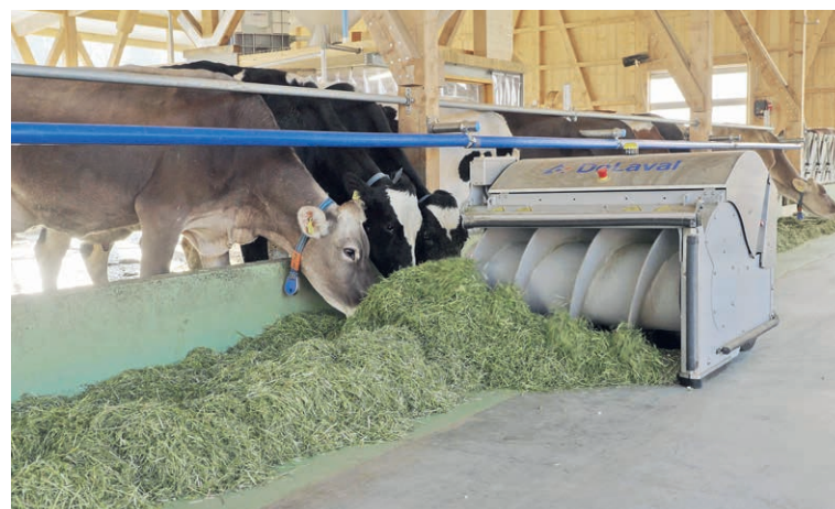
L'OptiDuo rafraîchit le fourrage six à huit fois par jour, ce qui permet une consommation élevée de fourrage de base.
