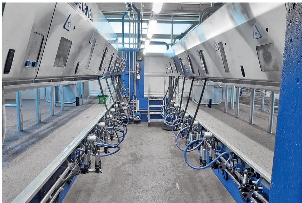
Confort de la vache et du trayeur: la salle de traite parallèle P2100 de DeLaval est équipée de compteurs à lait MM27 agréés ICAR. La traite est effectuée avec l'unité de traite MC73. La griffe de 350 ml gère facilement les flux de lait élevés, ce qui contribue à réduire la durée de la traite et à améliorer la productivité. Par ailleurs, le modèle MC73, particulièrement robuste, nécessite peu d'entretien.
