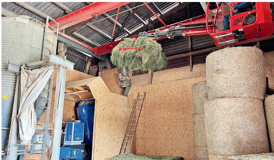
Compacte, la mélangeuse est peu encombrante. Le remplissage se fait d'abord avec la grue, puis l'Optimat™ Plus pilote automatiquement la fraise de désilage.
