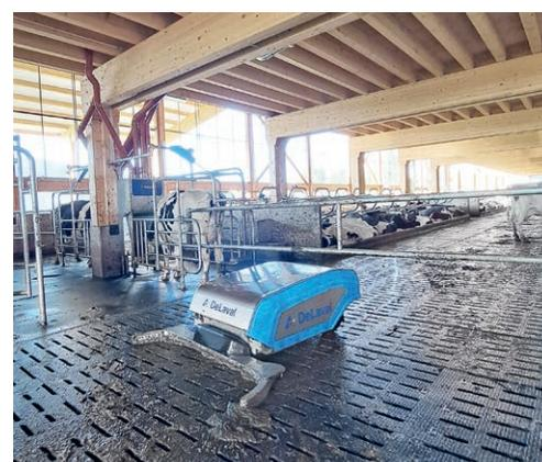
La propreté de l'étable est assurée par le robot racleur RS450 de DeLaval. En outre, l'étable dispose de deux stations de distribution de concentré Optifeeder et d'une porte de sélection située après la salle de traite.
