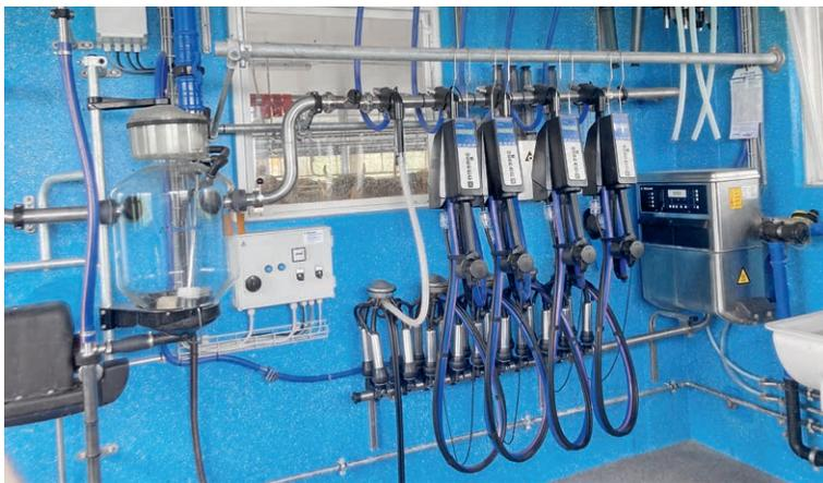
Équipement compact dans la chambre à lait avec l'unité terminale, 4 MU Blue et le programmeur de nettoyage C200.
