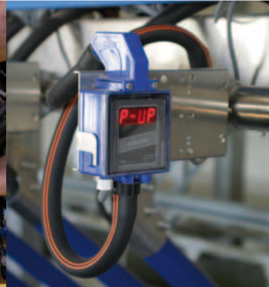
Compteurs à lait MM25 DeLaval – Précision grâce au système de mesure électronique à infrarouge
