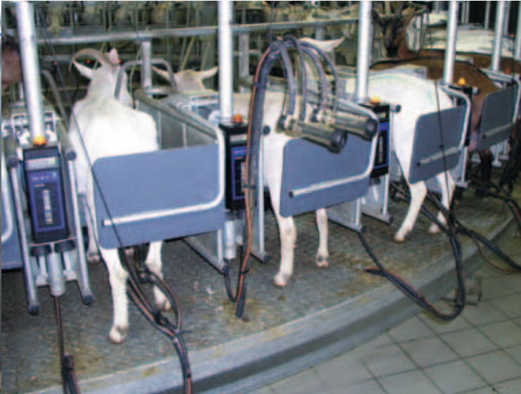
Salle de traite rotative SG DeLaval avec pilote de traite MPC510 SG
