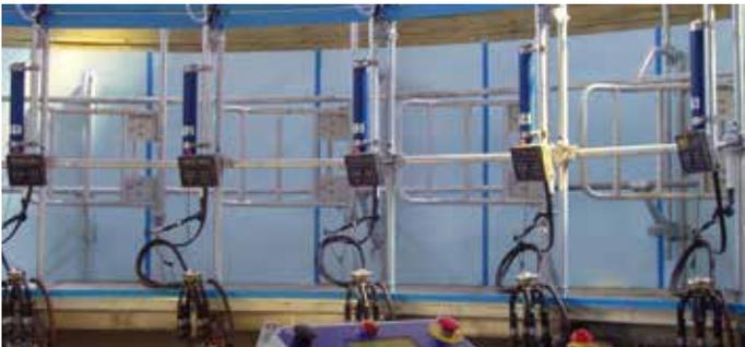
Die Platten sind schlagbeständig seitens Tiere oder stumpfen Gegenstände. Mit dem Zubehörmaterial werden Abschlüsse an Ecken und Kanten gemacht. Die Platten werden mit Spezialkleber und farblich abgestimmten Spezialschrauben befestigt.
