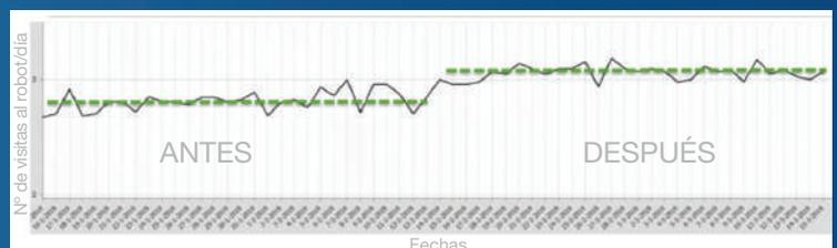
Gráfico donde se observa el número de visitas al robot de ordeño antes y después de colocar un OptiDuo en una granja comercial de DeLaval.
