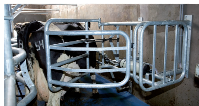
Przesunięcie bariery tylnej w HB50
