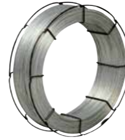
Forstrukket ståltråd (trippelgalvanisert til permanente gjerder) Den forstrekte ståltråden er stiv og har en høy strekkfasthet. Ståltråden er trippelgalvanisert med opp til ca. 300 g Zn/m 2 . Under normale forhold holder ståltråden i mer en 20 år.
