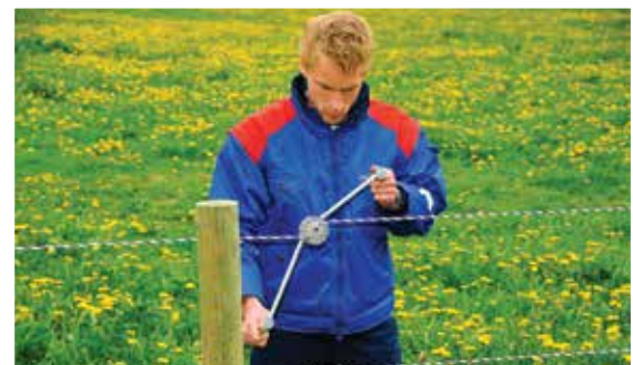
Bilde 20. Håndtaket gjør det enkelt å dra til trådstrammerene.
