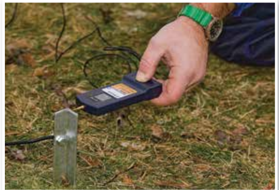
Bilde 26. Mål spenningen med DeLaval digitale voltmeter så får du klar beskjed om allt er OK.
