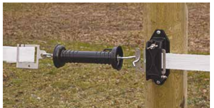
Bilde 7. Koble bandet til grindisolatoren.
