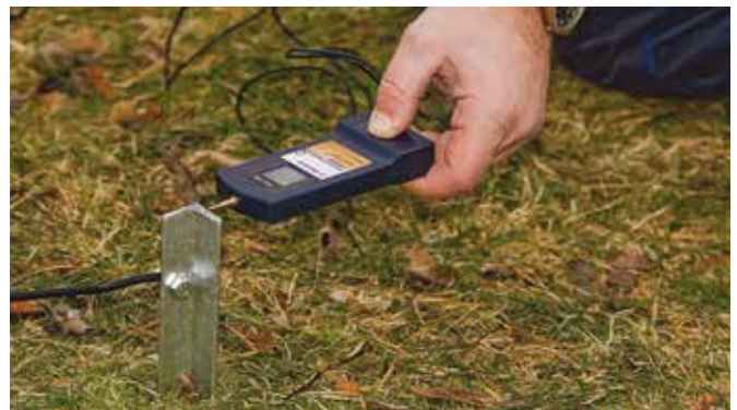
Bilde 15. Mål spenningen med DeLaval Digitalt voltmeter så får du sikker beskjed om alt er OK.
