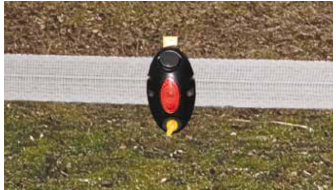
Bilde 14. Voltalarm gir raskt signal om spenningen på bandet er for lav.
