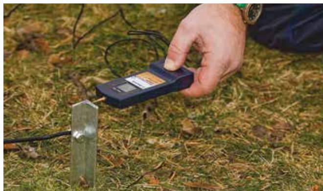
Bilde16. Mål spenningen med DeLaval Digitalt voltmeter så får du klar beskjed om alt er OK.
