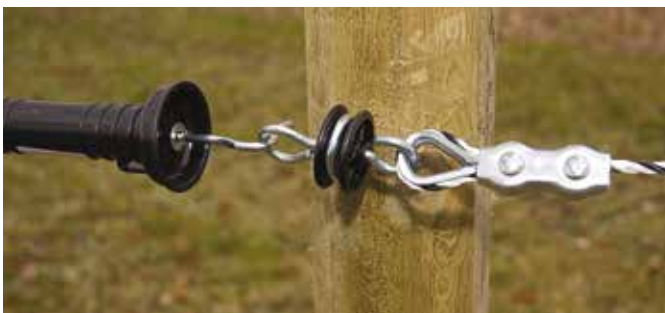
Bilde 7. Bruk kaus og trådskjøt med vingemutter. Gir sikker kontakt og lang levetid.
