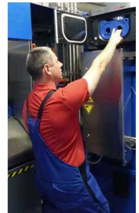
Dennis bij het vervangen van de cassette van de RePro module
