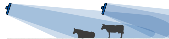
DeLaval ventilatoren werken met het principe van horizontale ventilatie voor luchtverversing en directe koeling
