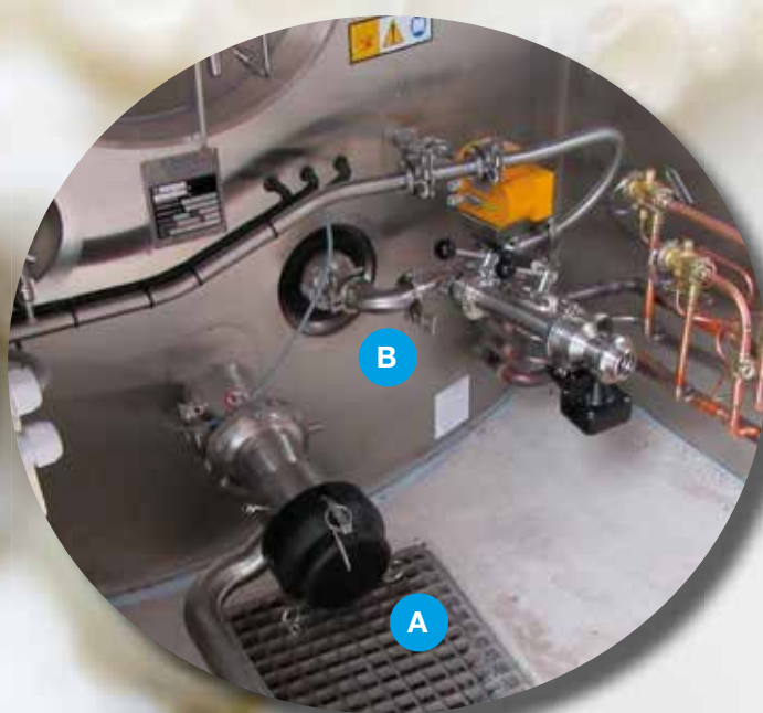
DX3S silotank met DN100 uitloop (A) en separate melkinlaat (B)
