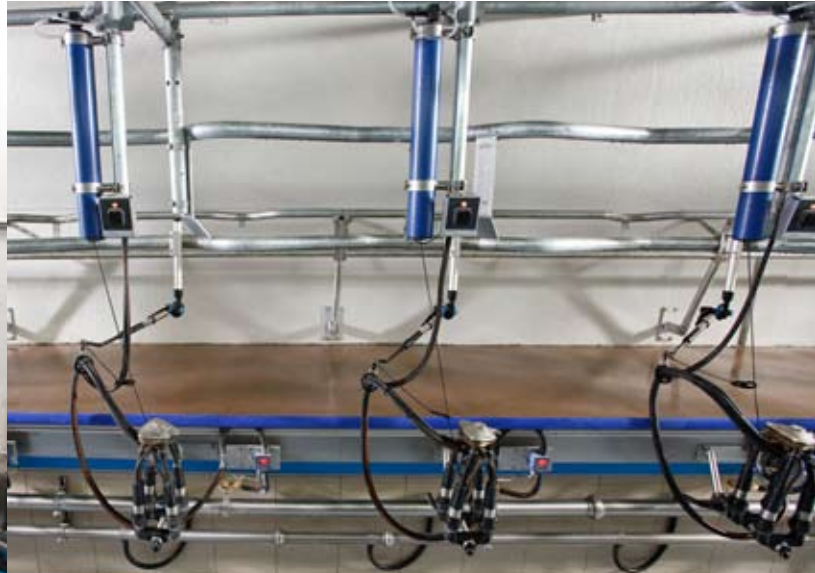
Pilote de traite MPC150 DeLaval dans une salle de traite en épi 30° HB30 DeLaval
