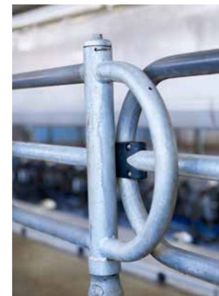
Sekvenslåge med stødfanger og indvendig fjeder
