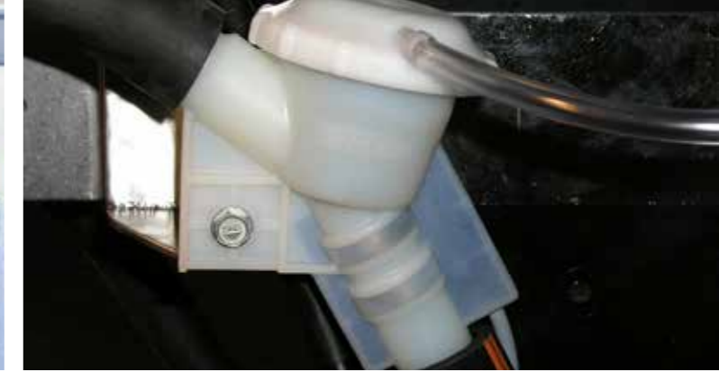
DeLaval HFC flowsensor har ingen indvendige bevægelige dele
