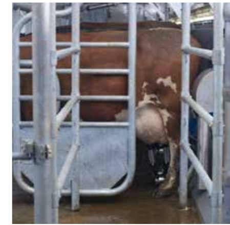
Indgangslåge skubber sidste ko forsigtigt ind i malkeposition
