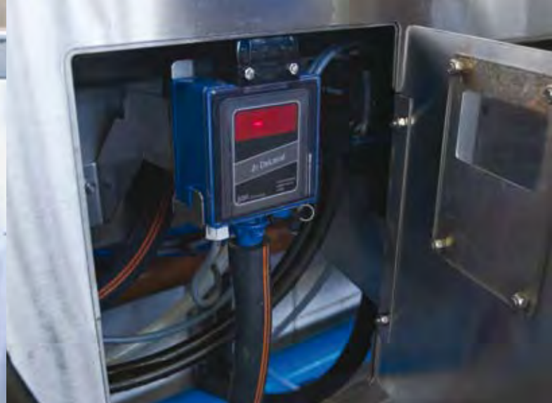
MM25 melkmeter in het onderkabinet achter een RVS deurtje met venster van plexiglas
