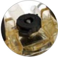
En option, la valve d'auto-fermeture coupe l'arrivée du vide au manchon en cas de chute accidentelle.
