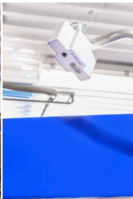
Die Position der BCS-Kamera am DeLaval Smart Gate oder am DeLaval VMS-Ausgangstor. Zusätzlich dazu kann sie am DeLaval Selektionstor installiert werden.
