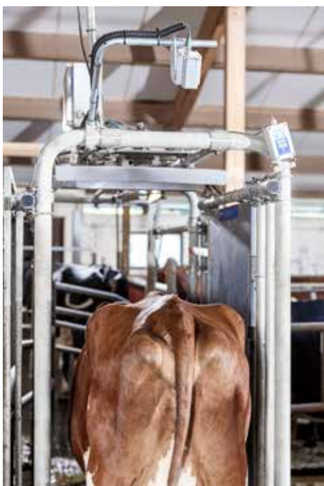
Die Position der BCS-Kamera am DeLaval Smart Gate oder am DeLaval VMS-Ausgangstor. Zusätzlich dazu kann sie am DeLaval Selektionstor installiert werden.
