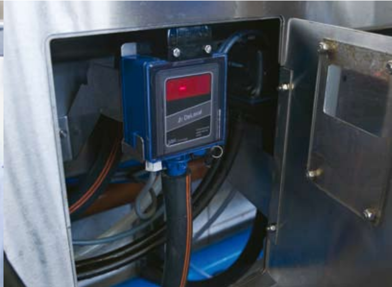
DeLaval MM25 – stor nøyaktighet med infrarød teknologi
