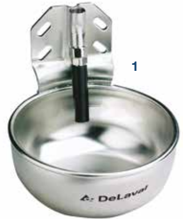
1. S22 itató Rozsdamentes itató, nagy tejhozamú teheneknek, szelep kapacitás 22 liter/perc. Méret (SZ×H×M) 25×26×24cm 90602883 S22 itató szeleppel 90602821 Szelep
