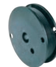
Câble souterrain DeLaval Pour connecter les piquets de terre et effectuer les connexions au niveau des barrières. Le câble est à double isolation et dispose d'un conducteur en acier galvanisé. Résistance à la tension d'environ 20 000 V – trois longueurs disponibles : 10, 25 et 100 m. Ø 1,6 mm, 10m. Référence 86675501 Ø 1,6 mm, 25m. Référence 98767235 Ø 2,5 mm, 100 m. Référence 88859601
