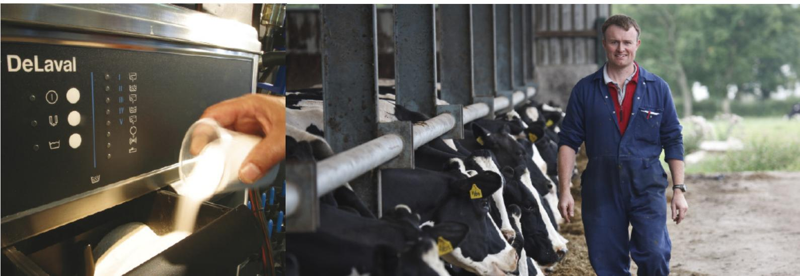
Simplement trois boutons permettent de contrôler le programmeur C100E. Le premier démarre le programme de lavage selon vos propres réglages. Le deuxième démarre la traite et le troisième permet la remise à zéro des messages des différentes diodes. Ces LED indiquent également le déroulement du lavage en cours.
