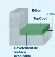
Après la pose de la couche de primer, le sable de quartz épaissi est mélangé avec la couleur choisie et enduit sur la surface au sol. Cette étape permet de rendre la surface régulière et lisse. Une couche de finition transparente (TopCoat) robuste peut être appliquée pour garantir la durabilité.
