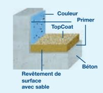
solide et anti-dérapante, processus commence par l'application d'un primer de protection. Une couche de revêtement de sable de quartz est appliquée pour garantir une adhérence sous le pied. La surface est ensuite recouverte d'un revêtement supérieur transparent anti-usure (TopCoat) composé de différents calibres de sable, pour garantir la parfaite combinaison d'adhérence, tout en évitant une abrasion indésirable.
