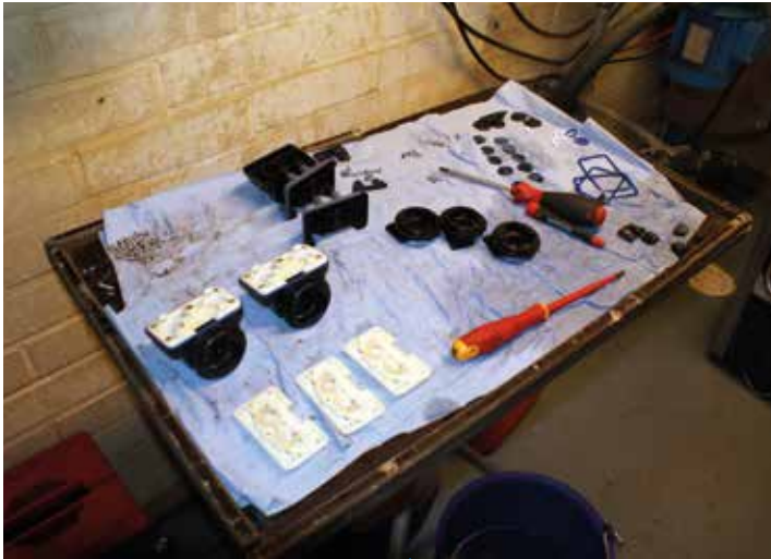
Huollossa lypsykone puretaan melko pieniin osiin. Kuluneet ja rikkoontuneet osat vaihdetaan uusiin. Laitteet pestään ja esim. tykkyttimet (kuvassa) kasataan ja testataan lopuksi.
