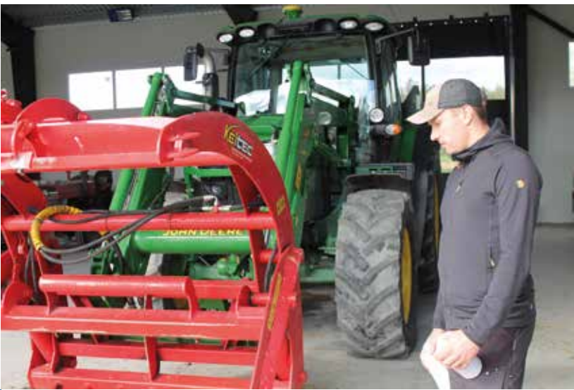
Etukuormaajan leikkuri halkaisee paalit ja ne nostetaan sillä seosrehuvaunuun.
