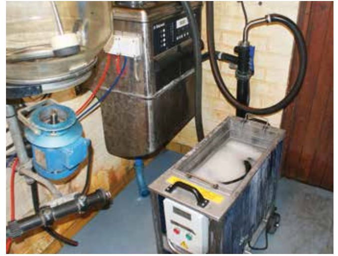
Huollossa lypsykone puretaan melko pieniin osiin. Kuluneet ja rikkoontuneet osat vaihdetaan uusiin. Laitteet pestään ja esim. tykkyttimet (kuvassa) kasataan ja testataan lopuksi.
