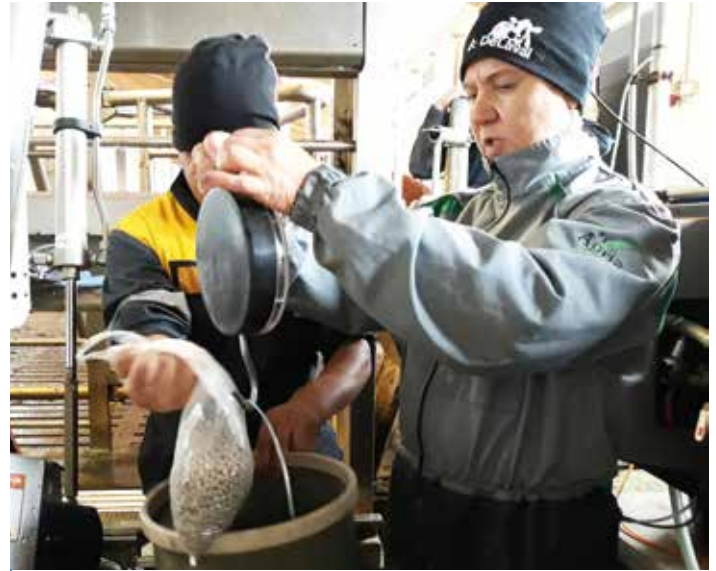
Rehuannoksen suuruus tarkistetaan vaatuksessa, jotta kalibrointi on tehty oikein.
