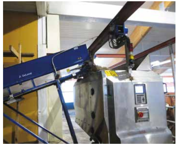
Ruokintavaunu täyttöpäikällä, josta se hakee tarpeen mukaan täydennystä.
