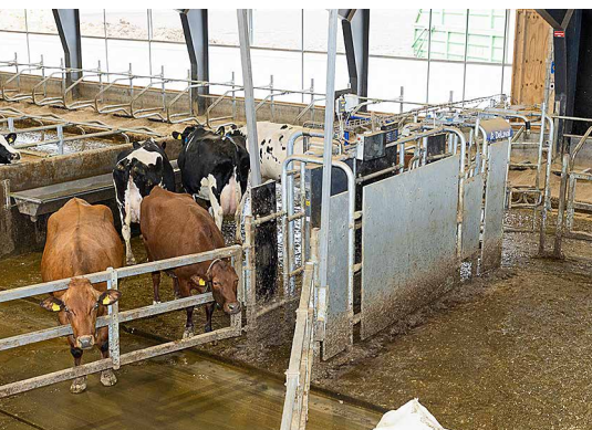
Die druckluftbetätigte DeLaval-Sortierschleuse DSG5 sortiert die Tiere sehr genau.
