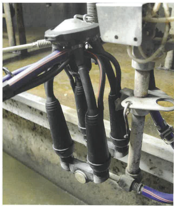
De kunststof onderdelen van het melkstel zijn met de waterslang goed te reinigen. Kunststof voelt niet koud aan en is snel droog. Dat melkt prettig.
