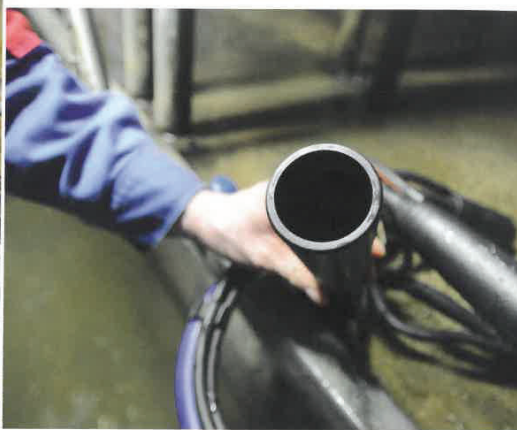
De tepelbekers van het Evanza-melkstel zijn iets conisch. Je klikt het tepelvoeringpatroon erin vast door het een kwartslag te draaien.
