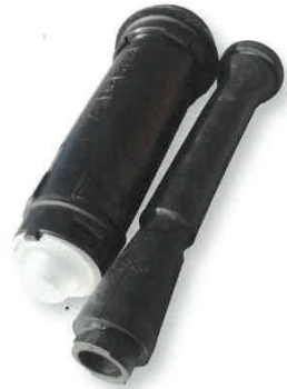
Een tepelvoeringpatroon en een korte melkslang met de bajonetsluitingen. De kop van de tepelvoering valt precies in en op de tepelbeker. De korte melkslang is niet langer onderdeel van de tepelvoering en vervang je apart. De interval voor de korte melkslang is dubbel zo lang.
