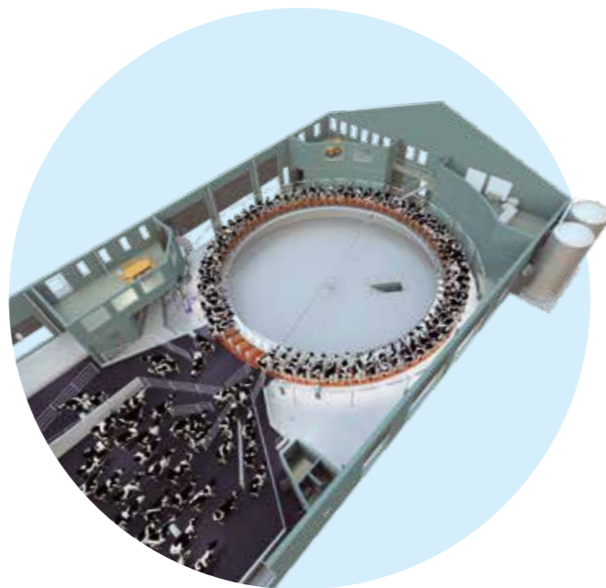
Exempel: Karusell med 70 platser med kapacitet att mjölka 2 000 kor.
