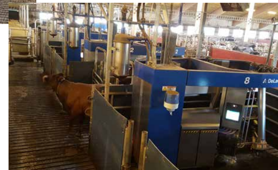
Korna kommer ut bakom robotarna och går tillbaka till liggbåsen genom korridoren. Det blir i snitt 2,5 mjölkningar per ko och dygn på sommaren och 3 på vintrarna.
