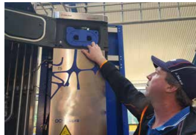
Kassetten med provstickorna är enkel att byta i DeLaval VMS V310.
