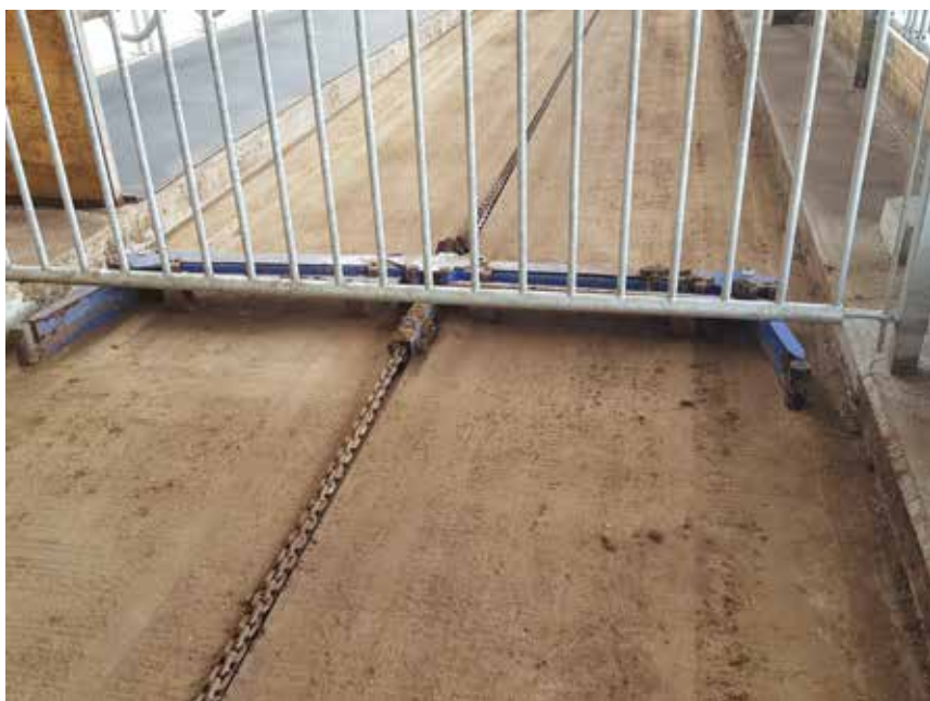
Utgödslingen är en AKD kättingutgödsling som kan köras både automatiskt och manuellt. Den kraftiga kättingen är mycket hållbar.
