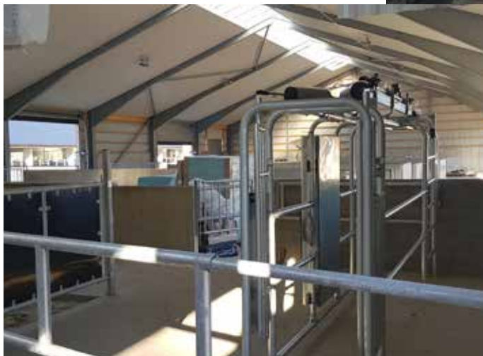
Selekteringsgrind som står här färdig att monteras på rätt plats
