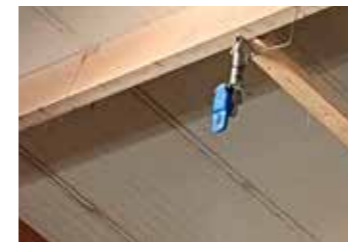
Mottagare placerade i taket får information om hur korna rör sig i stallet
