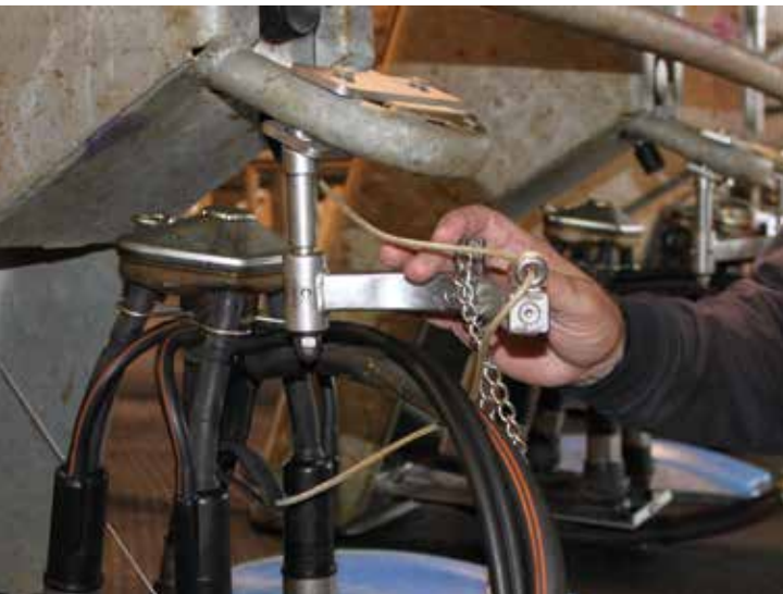
Servicearmen håller ihop slangar och ger en bättre helhetsfunktion och en renare avtagning
