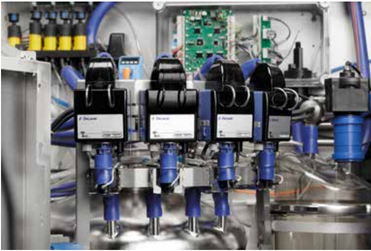
Mjölkmätarna sitter nu mycket lättåtkomliga för service och underhåll.
