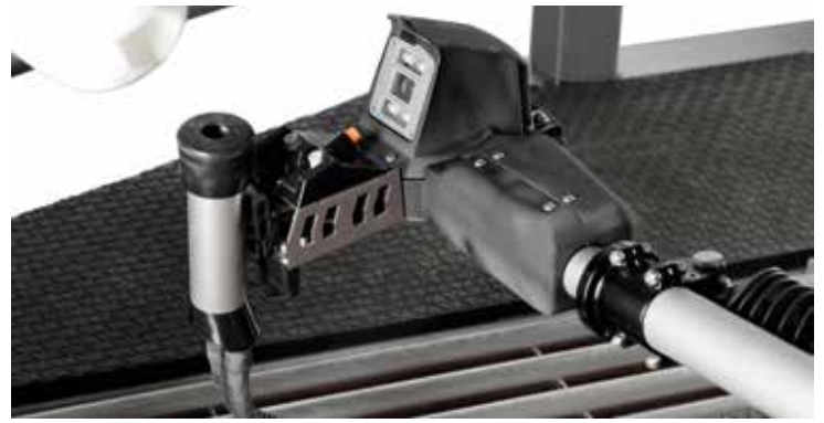
Den nya funktionen InSight™ gör att roboten hittar spenarna mycket snabbt.
