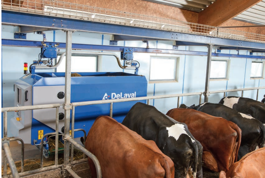
OTS100 on kompakti karkearehuvaunu pieniinkin tiloihin. Minimikorkeus kiskon alareunasta on 210 cm.
