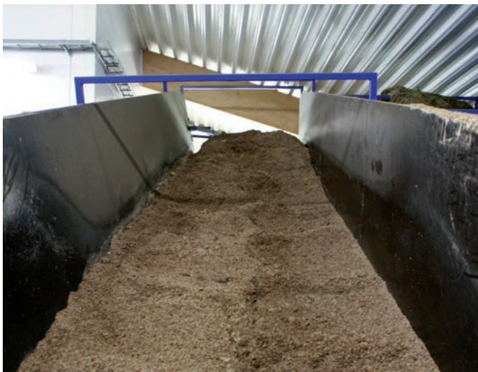
Seosrehun valmistus alkaa näiltä annostelupöydiltä. Kimmo ja Sami vastaavat, että pöydillä on tasalaatuista tavaraa aina kun sitä tarvitaan.
