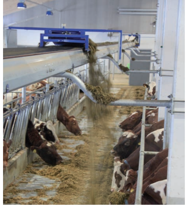
DeLaval matoruokkija BF 500 on monipuolinen laite. Halutessa voidaan koko automaattijärjestelmää ohjelmoida ja hoitaa PC- ohjelman kautta – konttorista käsin.
