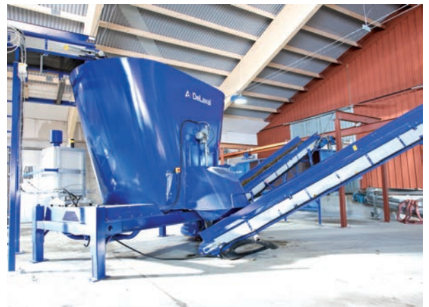
DeLavalin pystymallisia kiinteitä sekoittimia on saatavana tilavuudeltaan 8,12, 20 ja 24 kuutiometrin kokoisina. Sekoittimet tekevät kuohkean ja maittavan seoksen joka jaetaan automaattisesti esim. tunnin välein – täysin automaattisesti, myös syötetäessä pyöröpaalirehua.
