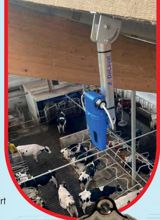
DeLaval DeepBlue ist ein ausgefeiltes Modell zur Erkennung des Kuhverhaltens. So bei der modernen Brunsterkennung: Aktivität, Wiederkäuen und Fressverhalten der Kühe werden gemessen, und die Brunstwahrscheinlichkeit berechnet. Eine Liste der zu besamenden Kühe wird erstellt und der beste Zeitpunkt für die Besamung ermittelt. Das alles führt zu einem superguten Ablauf im Milchviehstall.
