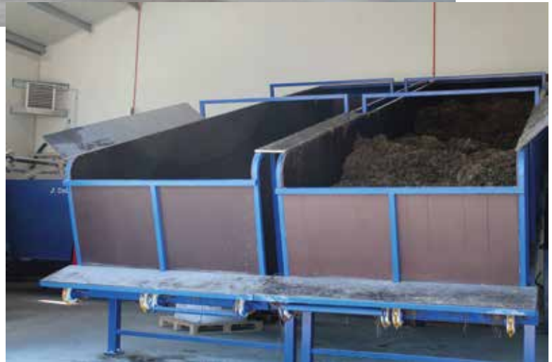
Tilavassa rehustamossa ovat kiinteä apesekoitin, ruokinnan ohjauskeskus ja täyttöpöydät sekä matoruokkija, jonka päädyistä otetaan valmista rehuseosta toiseen navettaan jaettavaksi.
