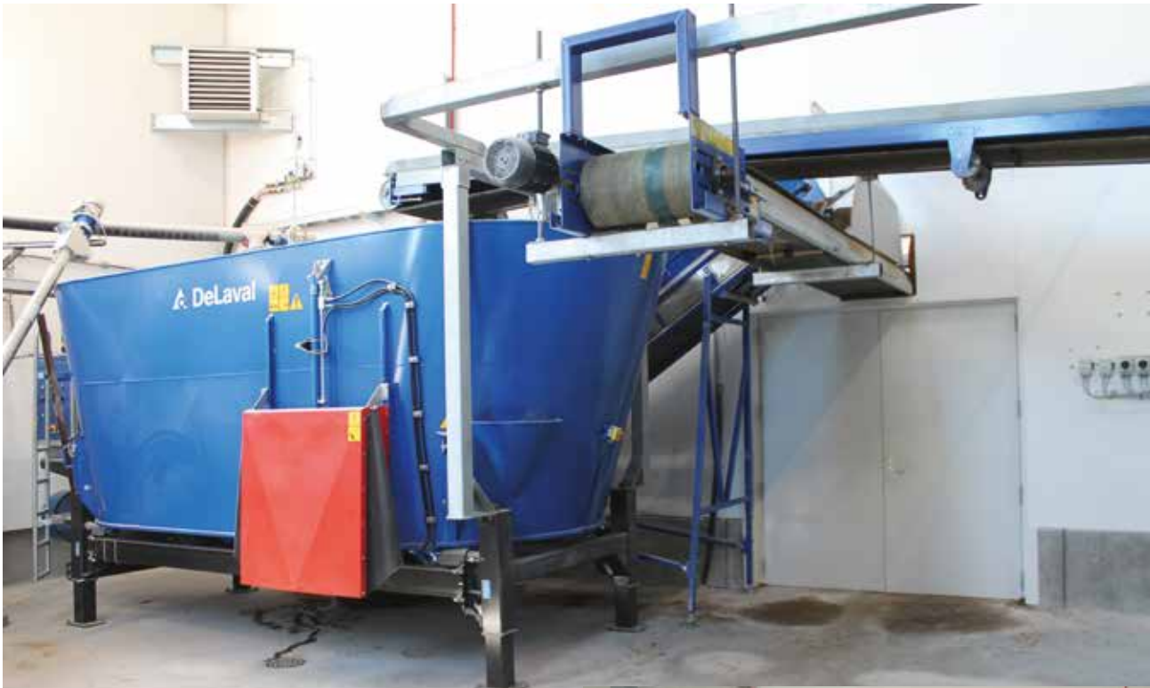
Tilavassa rehustamossa ovat kiinteä apesekoitin, ruokinnan ohjauskeskus ja täyttöpöydät sekä matoruokkija, jonka päädyistä otetaan valmista rehuseosta toiseen navettaan jaettavaksi.
