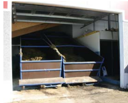
Säilörehu lastataan kahdelle 9 metrin täyttöpöydälle. Niitä voidaan kauko-ohjata traktorin ohjaamosta.
