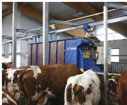
RA135-säilörehuvaunu täyttää itsensä automaattisesti ja jakaa rehua 12 kertaa vuorokaudessa.
