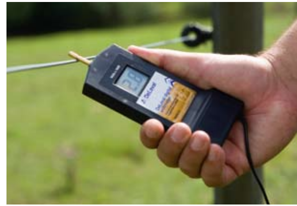
Digitaalinen volttimittari on mainio apuväline aitaamisessa. Sen avulla on helppo tarkistaa aidan kunto ja vikojenkin etsiminen on helpompaa.
