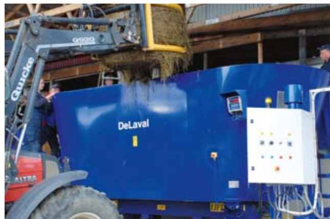
Sekoittimesta löytyy 2 kpl pystyruuvia jotka sekoittavat pyöröpaaleja vaivattomasti.
