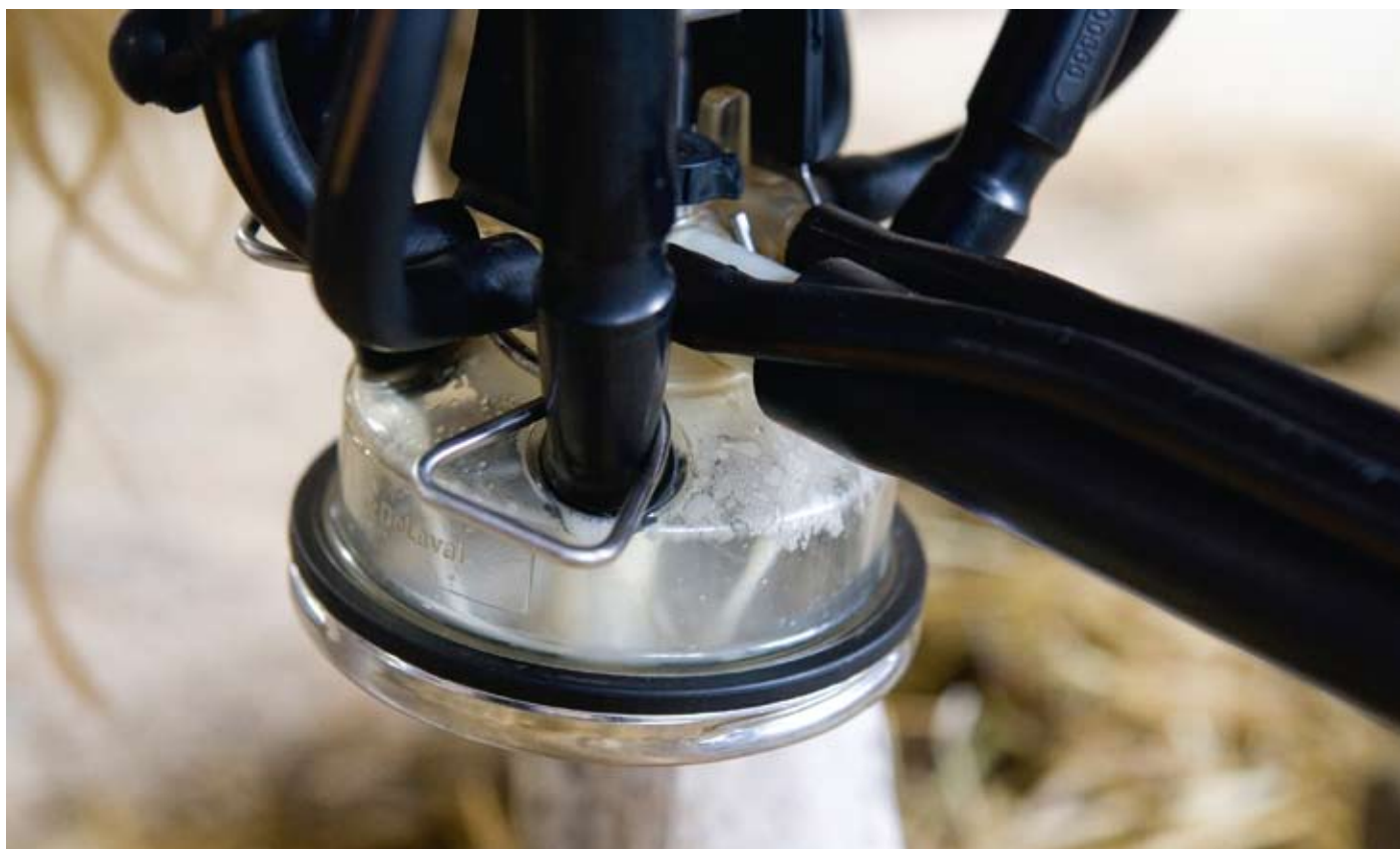
Harmony™-nännikumi kiinnittyy keskuskappaleeseen huuloskiinnityksellä. Näin nännikumista on suora kanava keskuskappaleeseen, ilman ahtaita nippoja.
