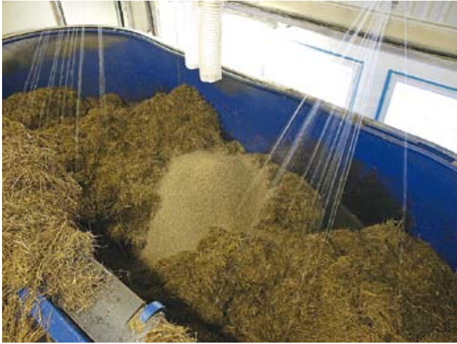
Seokseen on lisätty väkirehuseos ja meneillään on veden lisäys. Hetken kuluttua ruuvit sekoittavat täysrehun lyhyeksi silputtuun, kostutettuun säilörehuun ja seos on valmis jaettavaksi lehmien eteen.
