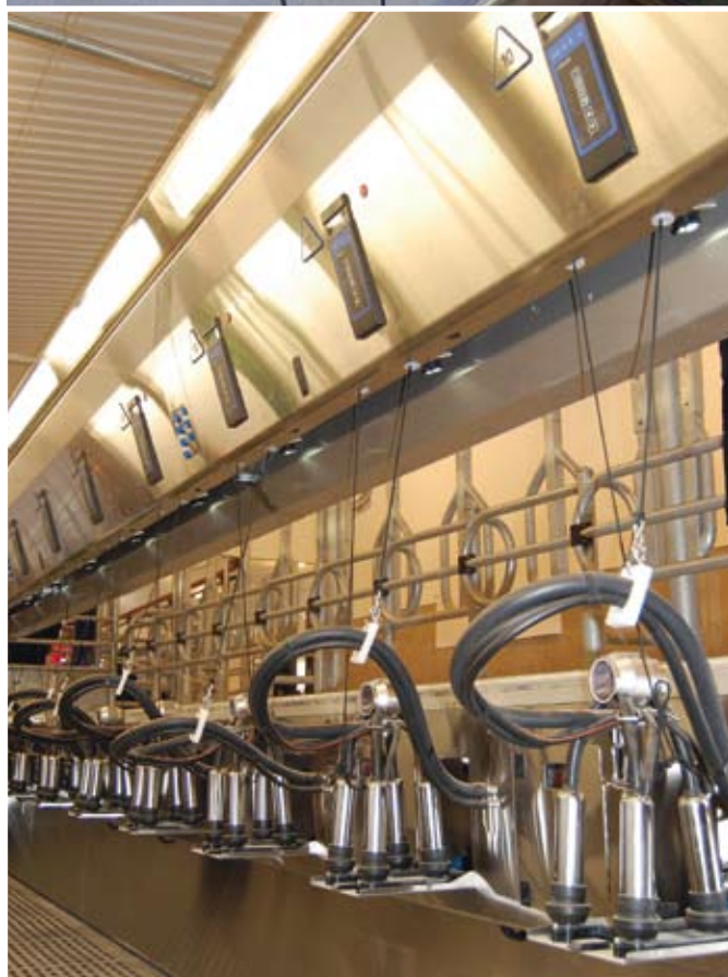
Ruostumattomasta teräksestä valmistettu alakotelointi suojaa laitteistoa, joka on sijoitettu lypsymonttuun. Ovet suojaavat maitomittareita, lypsinten pesutelineitä ja tarvikkeita. Lypsinten pesutelineet avautuvat juuri oikealla korkeudella.
