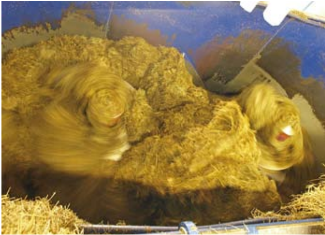
Rehusekoittimen pystyruuvit silppuavat pyöröpaalien rehun lyhyeksi silpuksi ennen täysrehun ja veden lisäystä.
