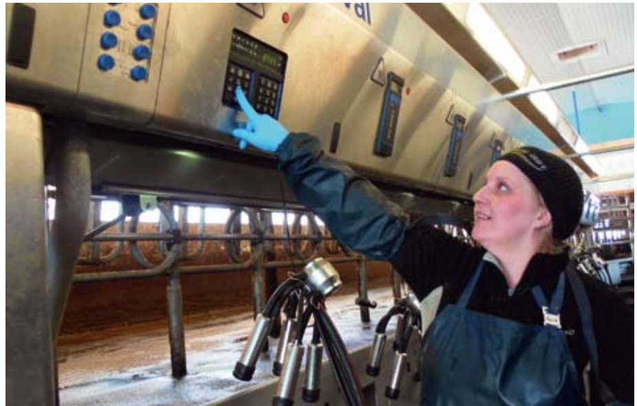
Anneliy Pääro avaa lypsyaseman tuloportin lypsytin alussa, jotta lehmät pääsevät asemalle. MPC610-paneelin käyttö on helppoa selkeiden painikkeiden ansiosta.
