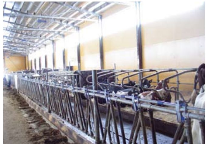
DeLaval HL10-lukittavia ruokinta-aitoja on saatavilla erikokoisille eläimille. Kaikki osat pultteja ja muttereita myöten ovat kuumagalvanoituja, joten ne kestävät ruostumatta vaativissa navettaolosuhteissa.
