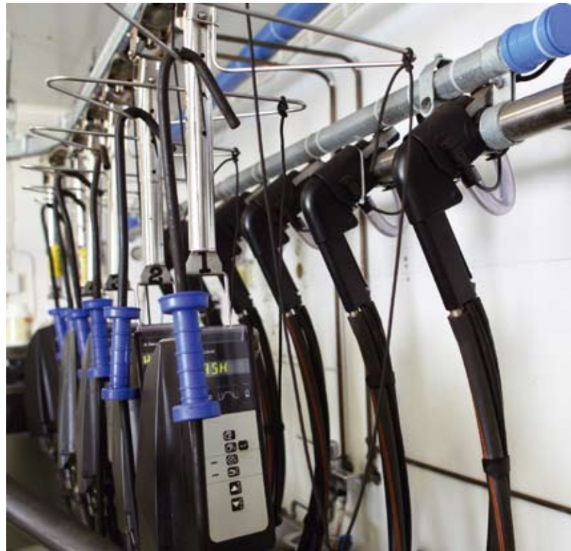
DeLaval MU480 on ICAR-hyväksytyllä maitomittarilla, sähkökykyisellä ja irrottimella varustettu lypsy-yksikkö. Se lähettää ja vastaanottaa tietoja langattomasti seinällä olevan lähettimen kautta tietokoneessa toimivan tuotannonohjausohjelman välillä. Langattoman tiedonsiirron ansiosta järjestelmä toimii kaikissa parsinavetoissa.
