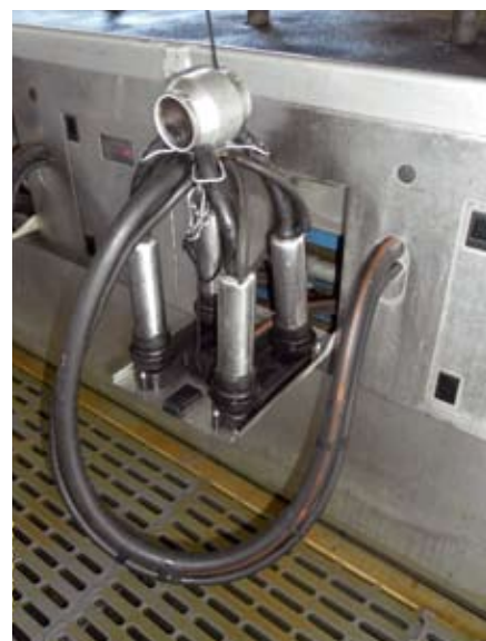
DeLavalin MC73-tynnryllysin sopii hyvin takalypsyyn, koska sen rakenne on kapea.
