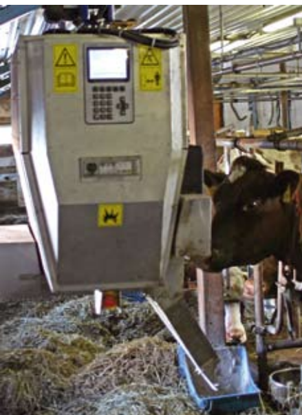
Väkirehun kiskoruokkija jakaa rehun suoraan lehmäkohtaisiin kaukaloihin. Ryöstely on loppunut käytännössä kokonaan. Väkirehun jako tullaan asentamaan päivittäisten maitotuotosten perusteella ohjatuksi.
