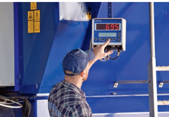
Optifeed-järjestelmän ydin on SI600-vaaka johon voidaan kytkeä kaikki seosrehun komponenttiannostelijat.
