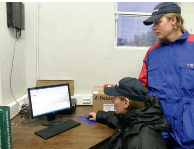
Pinolehdon navetassa on DelPro-tuotannonohjaus, johon on kytketty sekä DelPro-lypsy että ruokintavaunu. Bluetooth-yhteyden ansiosta kommunikointi on langatonta.
