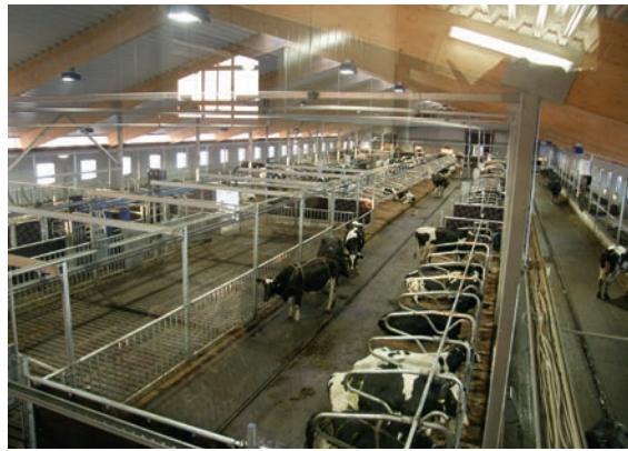
Navetta on väljä ja valoisa. Harjailmanvaihto tuo valoa pihattoon ja takaa erinomaisen ilmanvaihdon. DeLaval navettavalajärjestelmä tuo riittävän 180 luksin valaistuksen.
