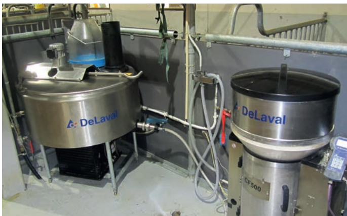
Erottelumaidot ohjataan vasikkalaan. Maito ohjataan kuvan 200-litraiseen tilasäiliöön, josta se saadaan helposti vasikanjuottoon. Maito voidaan ohjata myös viemäriin. Erottelulinja ja vasikanjuottolaitte peseytyvät automaattisesti, tilasäiliö vaatii käsipesun.
