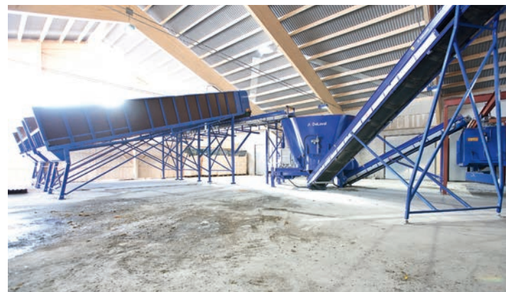
Optifeed-järjestelmän ydin on SI600-vaaka johon voidaan kytkeä kaikki seosrehun komponenttiannostelijat.
