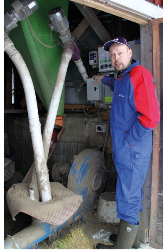
Kierukkakuljettimet siirtävät rehuseokseen ohraa ja kauraa halutussa suhteessa. Seossuhdetta säädetään kuljettimien nopeutta muuttamalla. Timo Mankki kehitti laitteen paikalliset tarpeet huomioiden.
