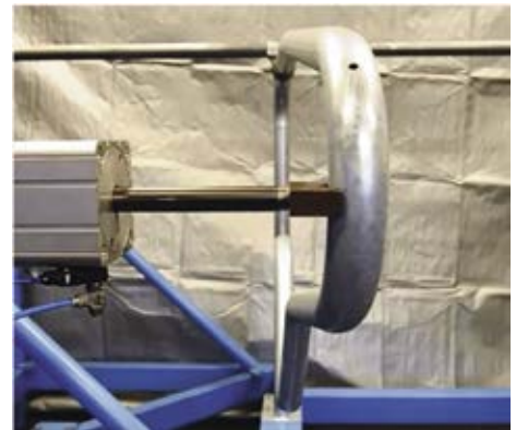
DELAVAL MAKUUPARSIIEN kestävyys testataan kuormituskokeessa, jossa parrelle annetaan toistuvaa, huomattavasti eläimen voimaa suurempaa kuormitusta.
